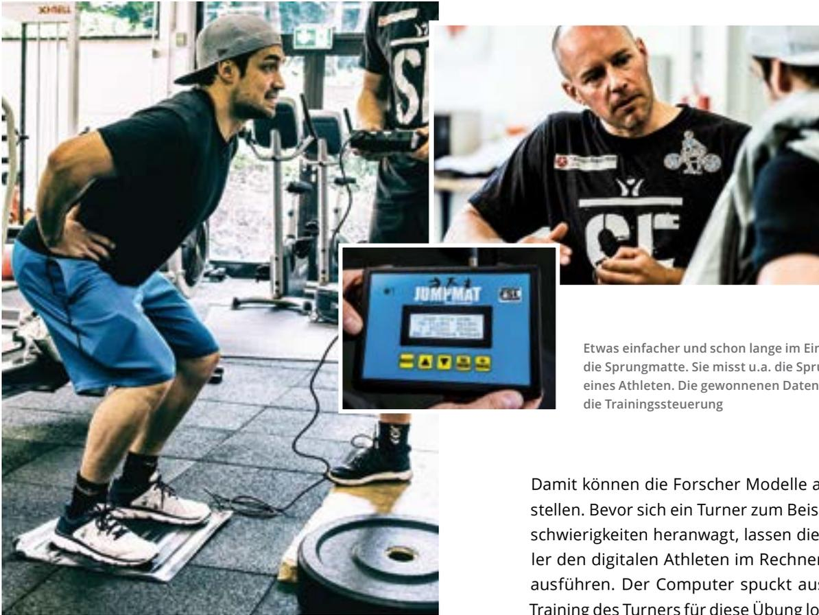
Etwas einfacher und schon lange im Einsatz: die Sprungmatte. Sie misst u.a. die Sprunghöhen eines Athleten. Die gewonnenen Daten fließen in die Trainingssteuerung
